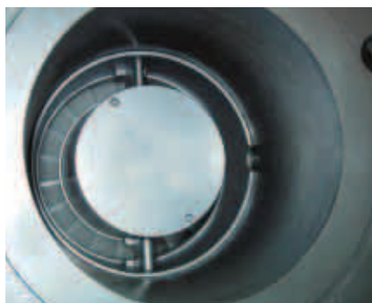
Interno di un misuratore a turbina dopo revisione
